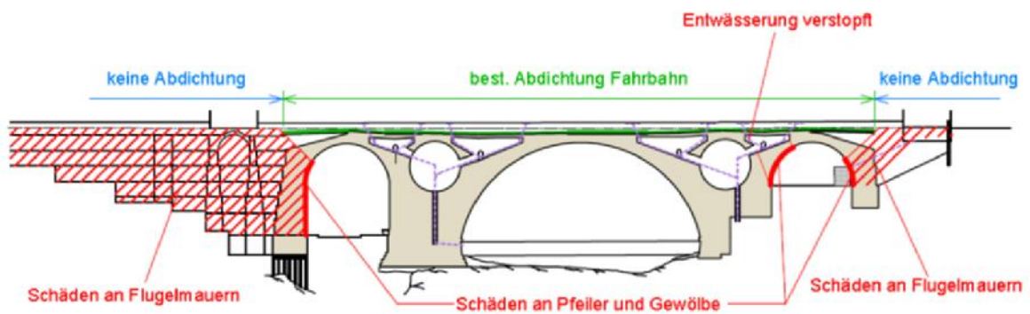
Fehlende oder defekte Abdichtung
